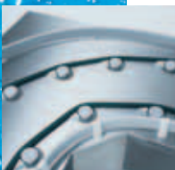
Angetriebene 180°-Kurve mit engstem Kurvenradius für kompakteste Bauweise als Rückführung oder Kreislauf der Geschirrkörbe. Auch als 90°-Kurve lieferbar.
