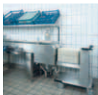
Automatische Tablett-Stackeinrichtung am Bandende auf fahrbaren Tablettstapler. Zuvor wird mittels eines Tastschalters überprüft, ob alle Geschirrtelle abgenommen sind.
